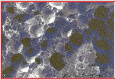
孔の大きさは、約1 $\mu$ mから5mmの不均質な構造です。様々な大きさの孔をもつため、バクテリア、原生動物、後生動物など多様な微生物の生息場所となります。
