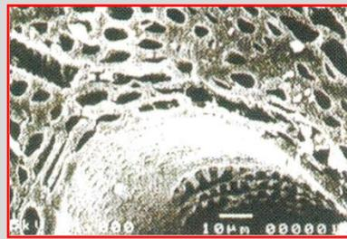
孔の大きさは、1nmから20 $\mu$ m程度の不均質な構造です。水道水中に含まれる微小物質の吸着除去には適していますが、目詰まりの危険性があるため浮遊物質が多い養殖水槽などのろ過には不向きです。
